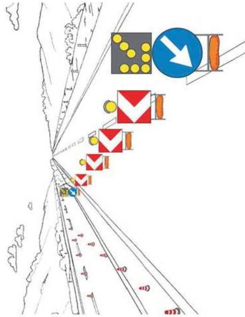
TESTATA DI SCAMBIO PER CANTIERE
