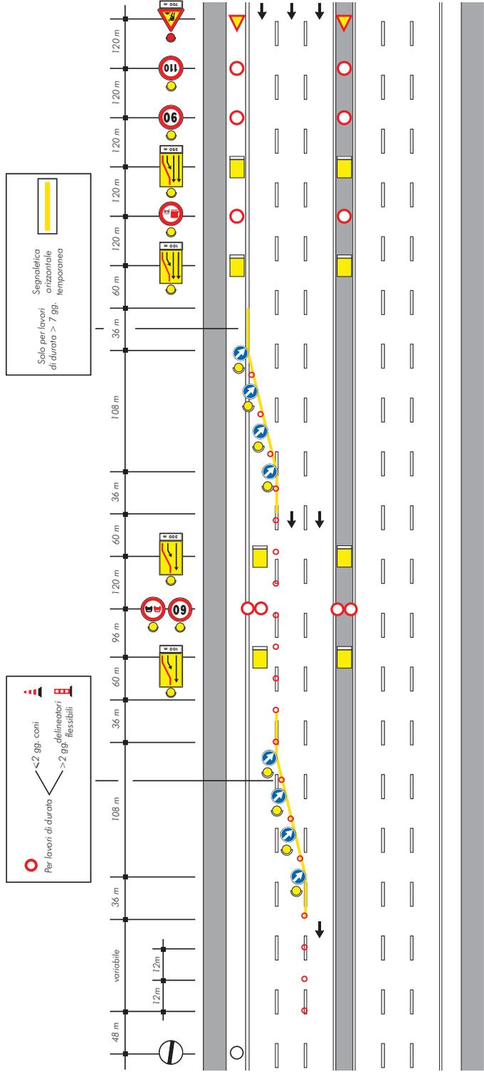
CHIUSURA DELLE CORSIE DI MARCIA E CENTRALE (con presegnalamento solo in destra)
