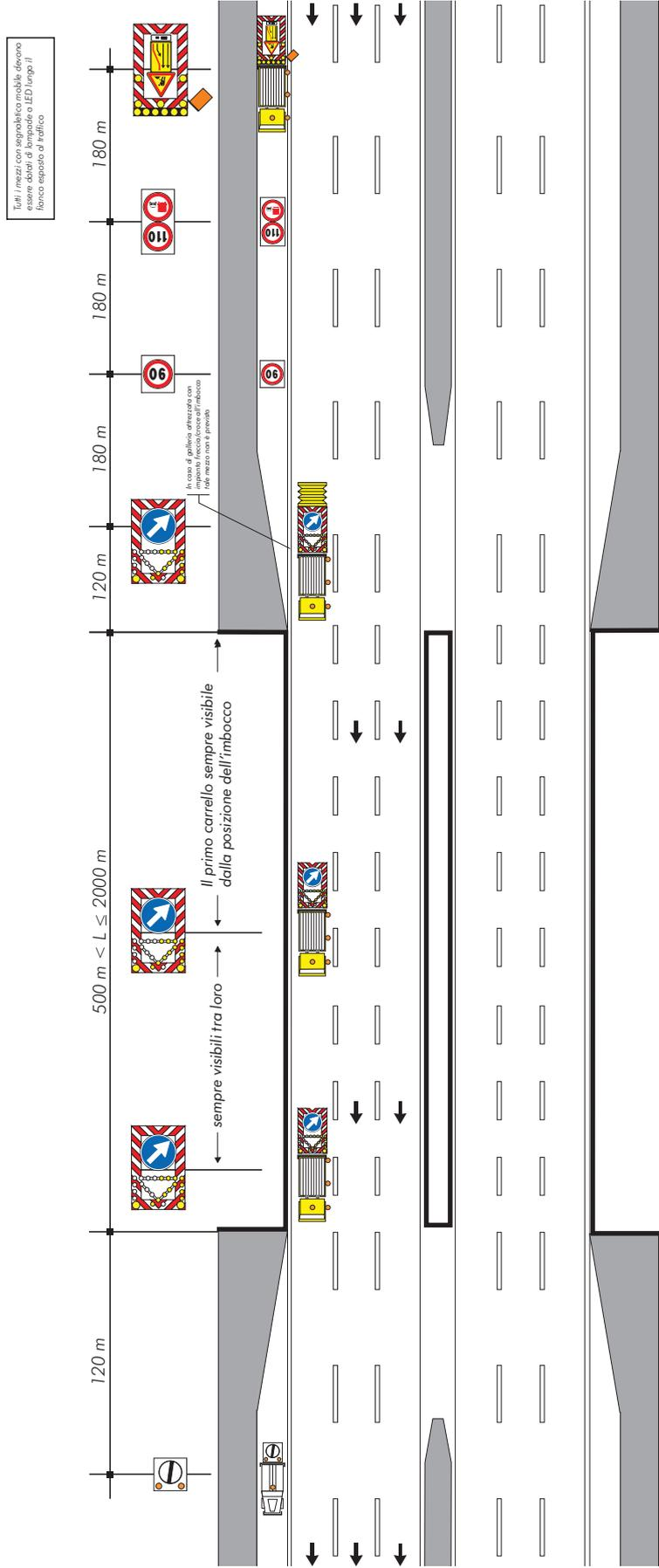
CANTIERE MOBILE IN GALLERIA DOTATE DI IMPIANTO FRECCIA/CROCE ALL'IMBOCCO (lunghezza della galleria superiore a 2000 metri)
