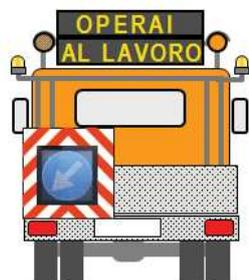
Figura 7: esempio di autocarro con PMV alfanumerico e disco direzione obbligatoria interamente a led.
