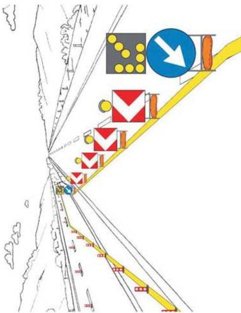
TESTATA DI SCAMBIO PER CANTIERE
