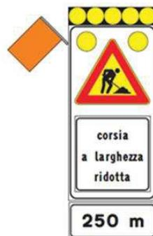
Figura 15: "presegnale di cantiere mobile" derivato dalla fig. Il 399/a Art.39 Reg., da impiegare per lavori sulla sola corsia di emergenza ridotta. E' integrato con set di 5 lampade a led ad alta efficienza luminosa diam. 200 mm (con possibilità di lampeggio sincrono e sequenziale) e con sbandiatore elettromeccanico posto in alto sul lato esposto al traffico.
